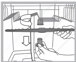
Для съема верхнего оросителя необходимо отвинтить против часовой стрелки пластмассовую гайку. Верхний ороситель устанавливается отверстиями вверх.
