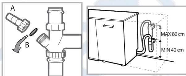
Перед подсоединением сливного шланга к сифону мойки снимите пластиковую пробку (В).
